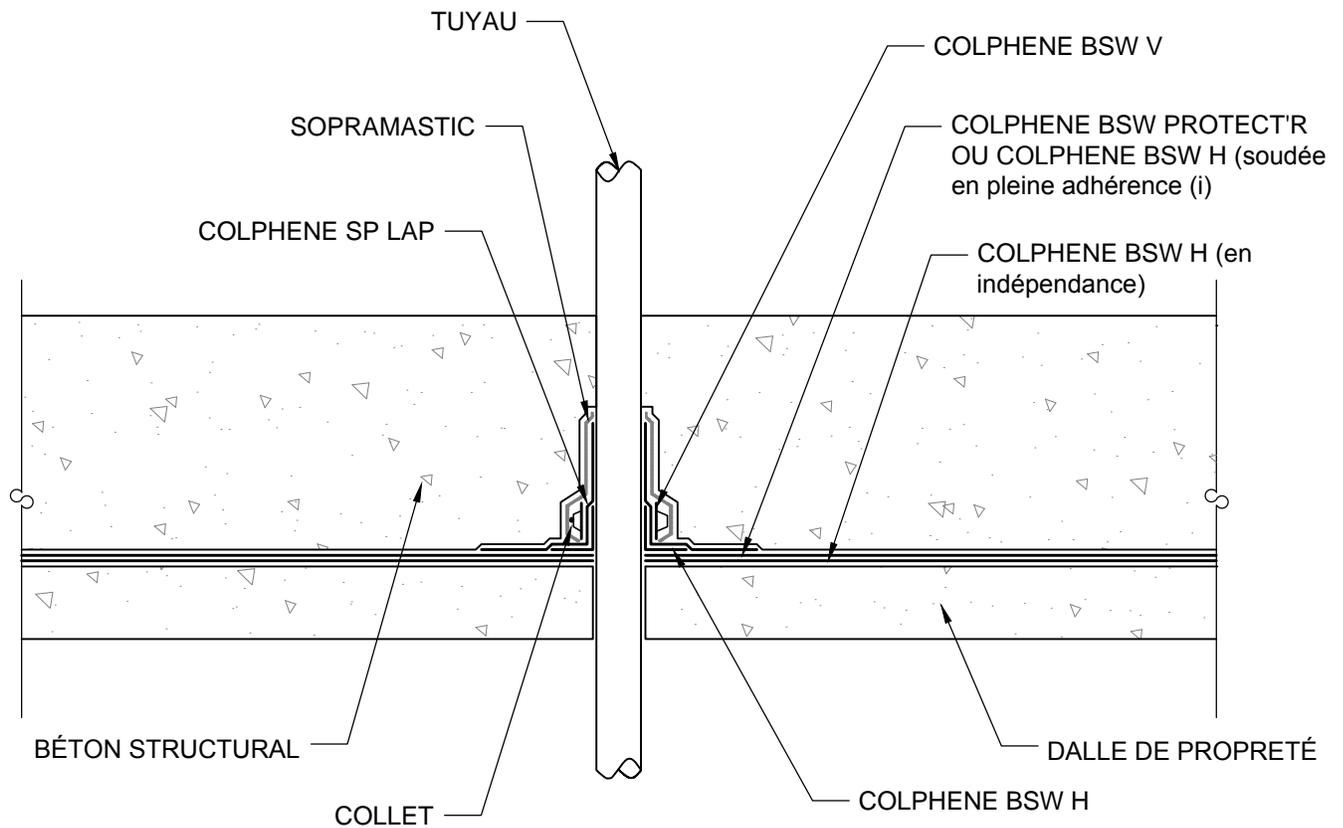
(i): Colphene BSW Protect'R est requis pour une application sous le plus haut niveau de la nappe phréatique. Colphene BSW H (soudée en pleine adhérence) est requis pour une application sous le plus haut niveau de la nappe phréatique pression hydrostatique élevée.
